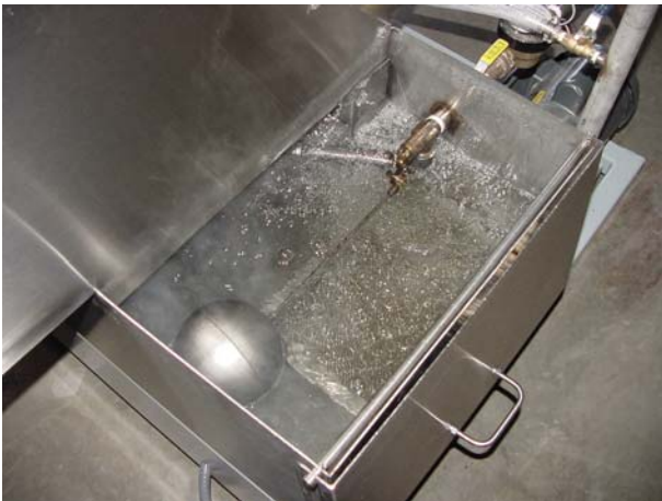
Le réservoir d'eau est accessible en fonctionnement en basculant le couvercle en acier inoxydable.
