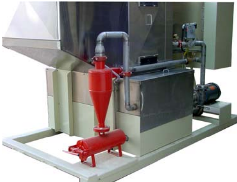
Un filtre hydrocyclone maintient le réservoir d'eau propre
